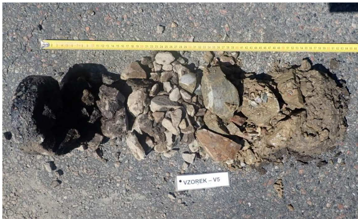
Obr. 9 - Jádro vývrtu Vzorek – V5 (in situ).
