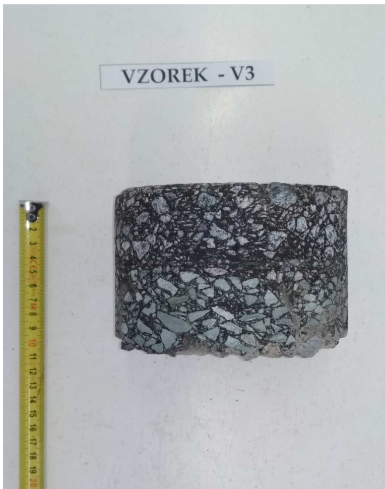
Obr. 6 - Jádru vývrtu Vzorek – V3 (laboratoř).
