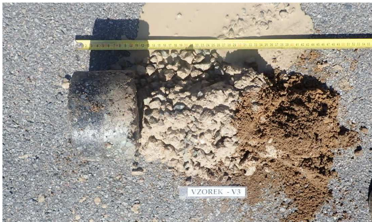
Obr. 5 - Jádro vývrtu Vzorek – V3 (in situ).
