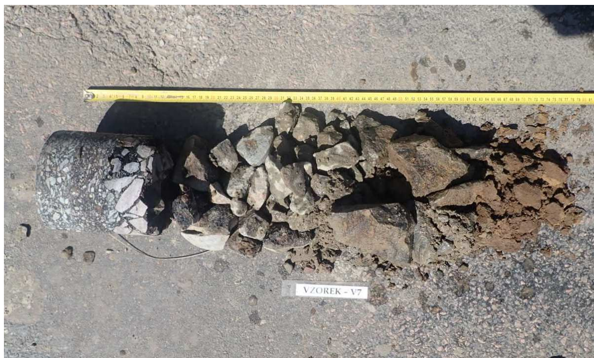
Obr. 13 - Jádro vývrtu Vzorek – V7 (in situ).
