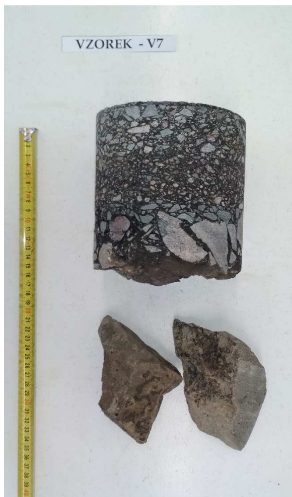
Obr. 14 - Jádru vývrtu Vzorek – V7 (laboratoř).
