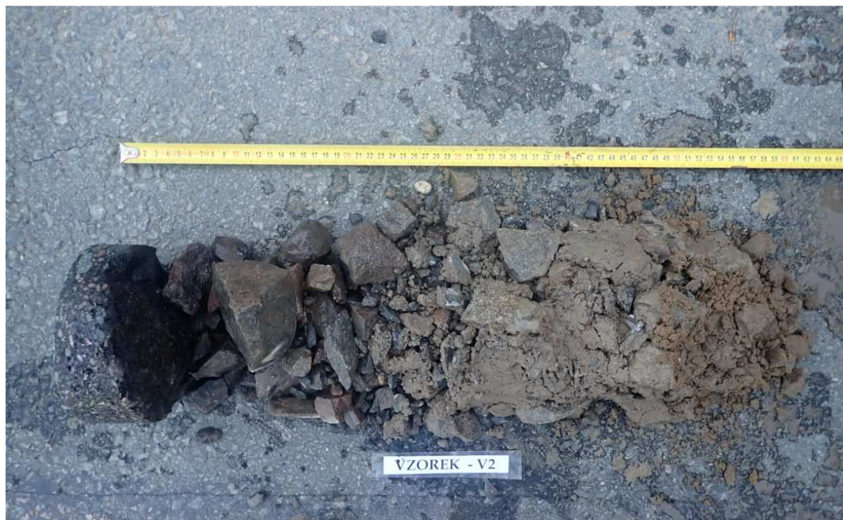
Obr. 3 - Jádro vývrtu Vzorek – V2 (in situ).
