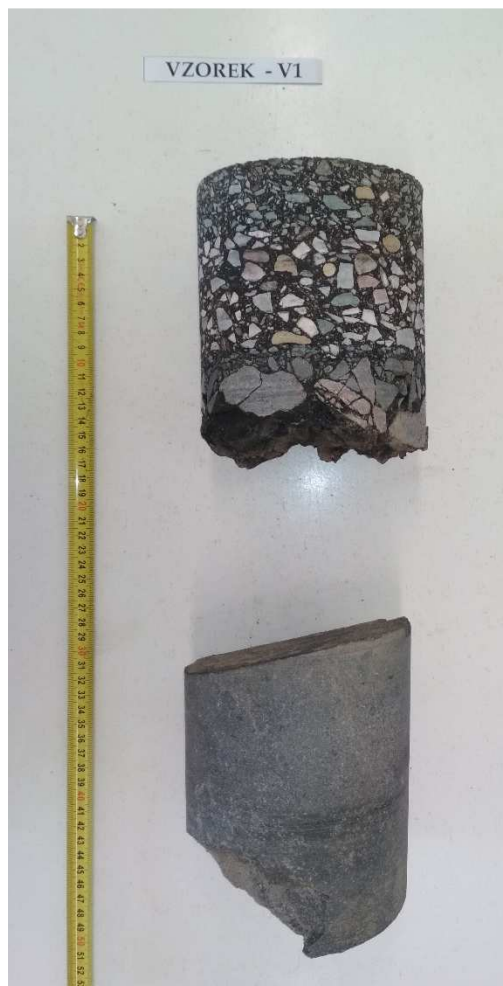
Obr. 2 - Jádro vývrtu Vzorek – V1 (laboratoř).
